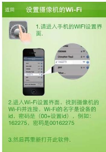
按照界面介绍，进入手机的“设置”界面，点击“Wi-Fi”，手机自动搜索可以访问到的 AP，找到摇头机的 AP，例如 161504，点击，手机将自动连接该 AP。连接成功后，再次进入 seetong 手机客户端，出现如下图所示的界面。该界面显示，软件将修改摇头机的 WiFi 设置，并且连接手机所在的无线网络，输入 WiFi 密码后，点击“确定”按钮。如果密码输入正确，手机和设备都将正确连接该 WiFi 网络，如果密码错误，设备将无法正常连接。
